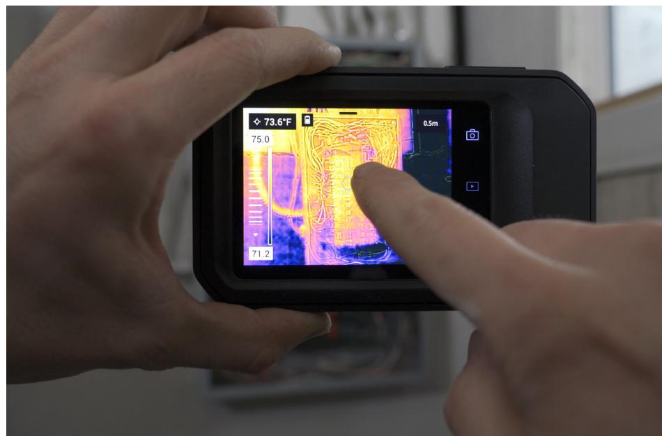
$160 \times 120$ , este dispositivo presenta un factor de forma compacto tipo "apunte y dispare" con una pantalla táctil que funciona con guantes y que cabe fácilmente en los bolsillos.
