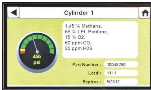
**Configuración automática RFID del gas de calibración, alertas de estado y trazabilidad.**
